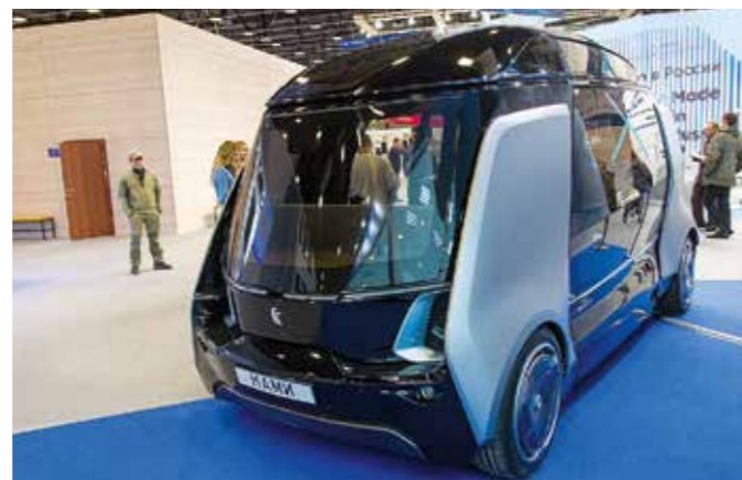
Беспилотный микроавтобус «Шатл» способен прокладывать путь в зависимости от потребностей пассажиров
